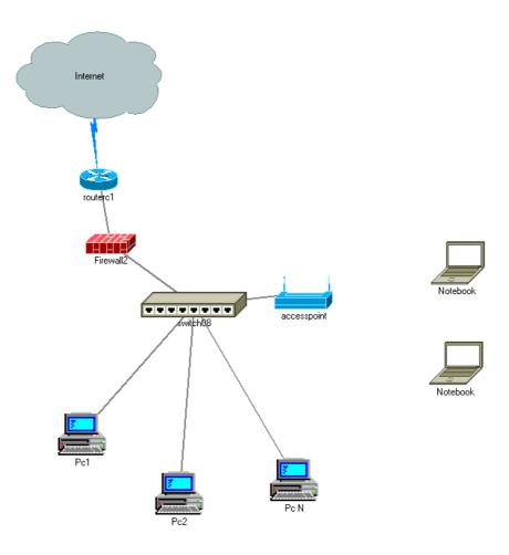
In molti casi il router, il firewall, lo switch, e l'access point, sono embedded in un unico apparato (un esempio potrebbe essere il prodotto della dlink dsl-604t).
